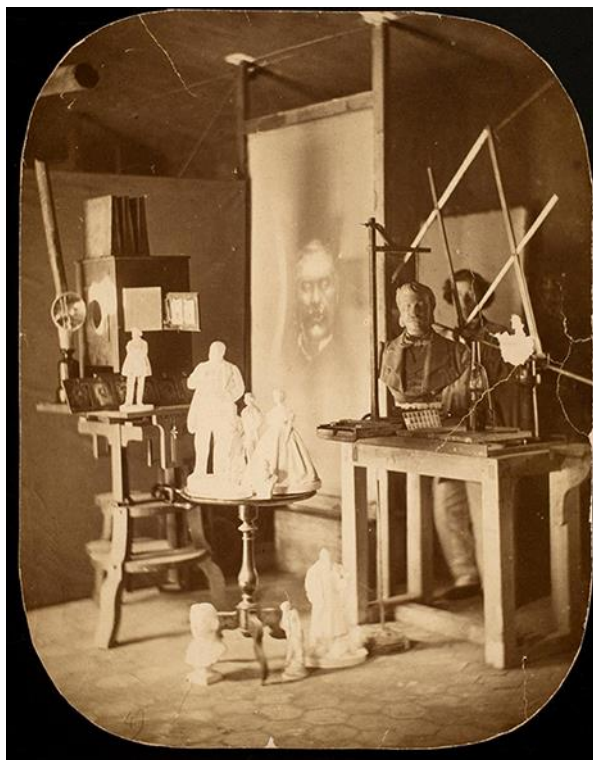
Figura 1. Aparelho de projeção e pantógrafo de François Willème (c.1865). George Eastman Museum.
