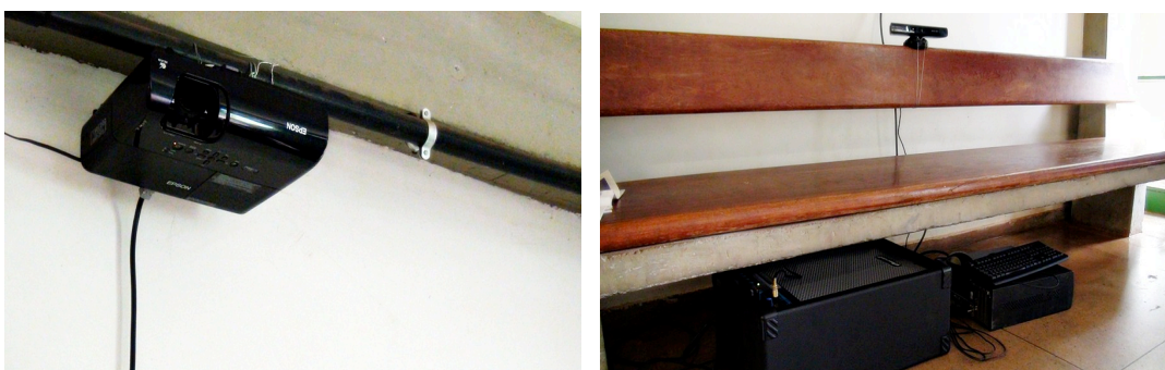
Figuras 8 e 9 - Estrutura de projeção da imagem da pintura Campos de trigo com corvos de Van Gogh. Aparato sonoro composto por uma caixa acústica amplificadora, computador desktop e aparato de detecção de movimento provido pelo Microsoft Kinect localizado acima do banco de madeira.
