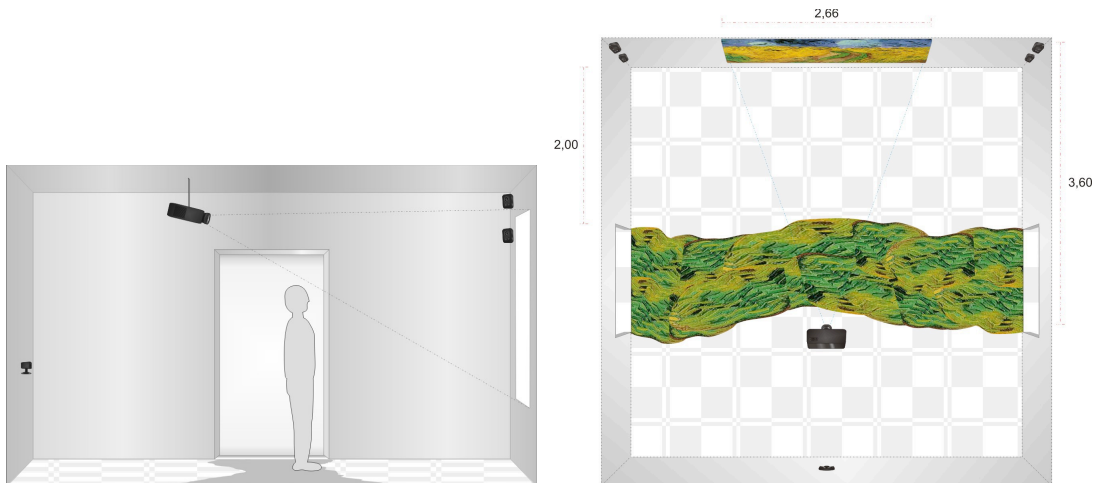
Figuras 6 e 7 - Diagramas da proposta de instalação com disposição do equipamento (vistas lateral - estudo de interferência - e superior - medidas da instalação).
