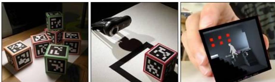
Figura 2: Marcadores Fiduciais impressos nas faces de um cubo.
