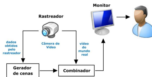
Figura 3: Sistema de RA baseado em monitor.
